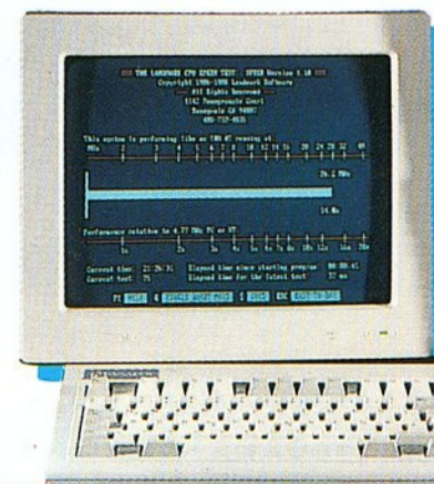
Dell System 220 – A jó elrendezésű házban még három bővítőkártjának s egy további lemezegységnek van hely
