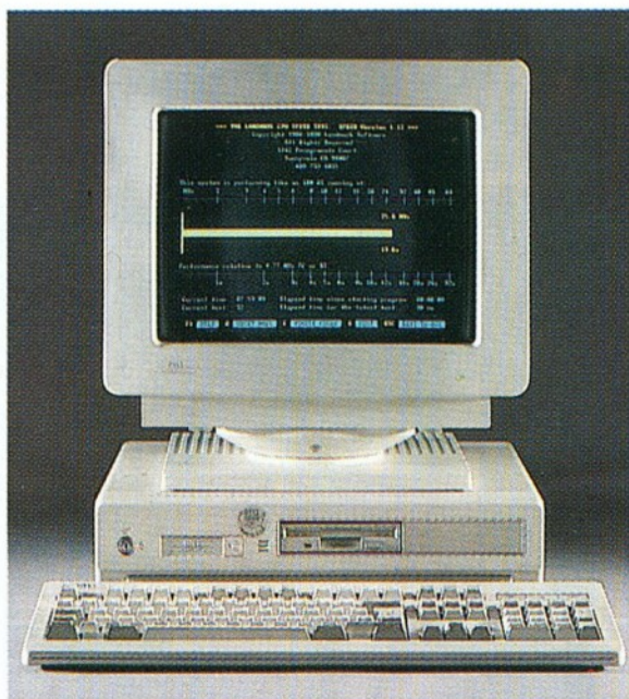
Dell System 220 – A jó elrendezésű házban még három bővítőkártjának s egy további lemezegységnek van hely
