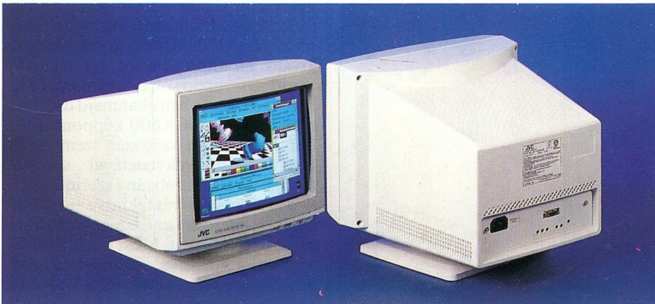
JVC GD-H3014SGE: 14 col, tesztfrekvencia-monitor (640×480)
