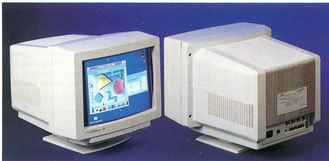
NEC Multisync 4D: 16 col, multiscan, 1024×768 képpontig
