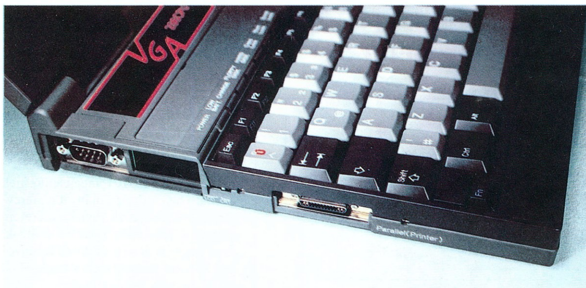
A laptop bal oldalán található a soros csatlakozó, illetve a nyomtató párhuzamos csatlakozója.
