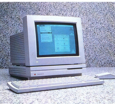
A Macintosh IIx belsejében 68030-as processzor búvik, amely – opcionálisan – még matematikai koprocesszorral is megoldható
