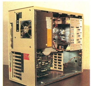
A Mitac MPC4000 G (fent). A Mitac belülről. Jól kivethető a processzor, a koprocesszor és a bővítőkártya sora (balról). A piros cédula a hátoldalon a Novell cég bevizsgálására utal (jobbról)
