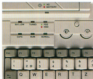
CAF: funkció-ellenőrzés LED-ekkel, praktikus képernyő-beállítás
