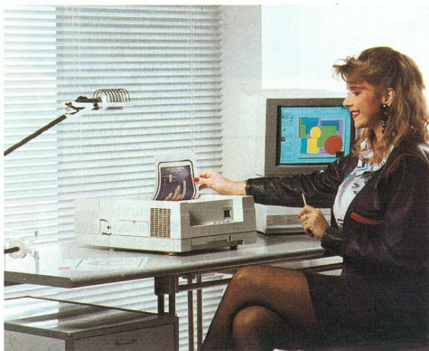
A színes nyomtatás olcsóbb alternatívája a Mannesmann Tally MT7400 TCR Color tintasugaras nyomtató. A tintát négy fej 15 „dűznije” spricceli a papírra, 300×300 pont/inch felbontással. Nagy előnye, hogy a színes mechanikát egy modulattal monochromra cserélhetjük, ily módon a próbáképek költsége töredéke a színesekének. A nyomtató ára csak 5350 DM.
