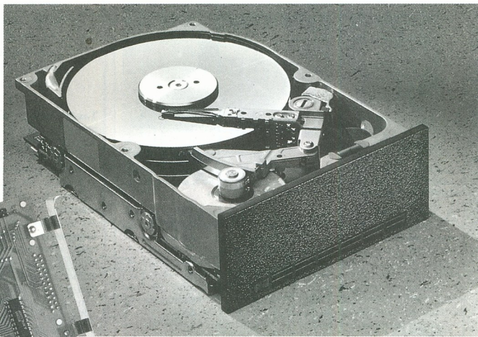
Bonyolult finommechanika egyszerű köntösben: ilyen egy tipikus merevlemez
