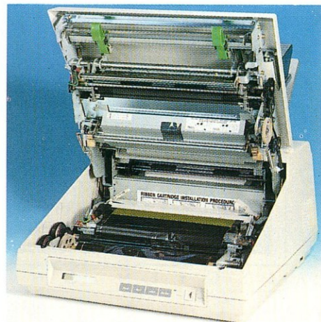
A festékszalag kényelmesen behelyezhető a felső fedél alá, és bármikor jól elérhető
