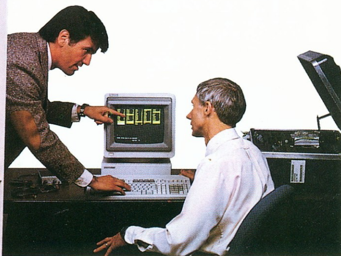
A HP automatikus adagolóval felszerelt dopingellenőrző rendszere – külső beavatkozás nélkül – 100 mintán végzi el a vizsgálatot
