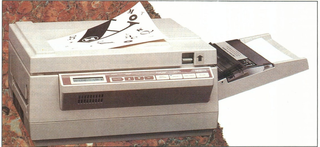
Az „igazi” lézerprinter: a TrueLaser a Microtektől 300 dpi-s felbontású, percenként hat oldalt nyomtat, és beszéli a nyomtatók valamennyi dialektusát
