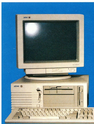
A Mitac 4270E számítógép kiépítése a 486-os gépekre, teljesítménye pedig a gyors 386-osokra utal. A gép nagy kapacitású winchestere SCSI vezérlésű
