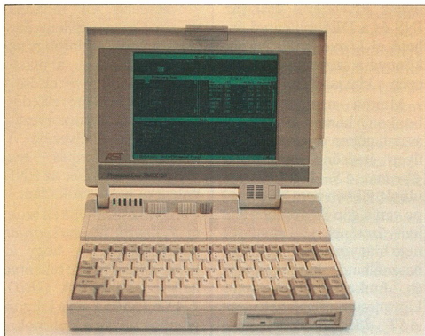
Az AST notebook hangszóróját az egyik zsanérba építették
