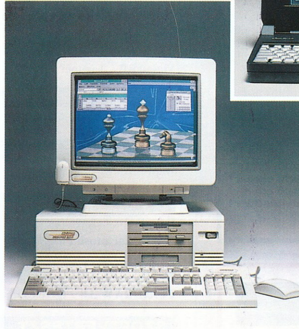
Egy igazi nagymenő: a Deskpro 50M. Tervezői 50 MHz-es 486DX2 mikroprocesszorral, 8 Kbájt cache-memóriával, 387-es koprocesszorral és Weitek 4167 koprocesszor foglalattal vértették fel
