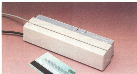
A Nokia FMID 200-as mágneskártya olvasója a lakossági pénzforgalomban, valamint a biztonságtechnikai alkalmazásokban egyaránt használható, és bármely ISO szabványú kártya fogadására képes
