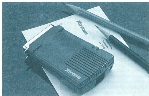
A Xircom zsebméretű print servere LAN környezetben is lehetővé teszi az elosztott nyomtatást
