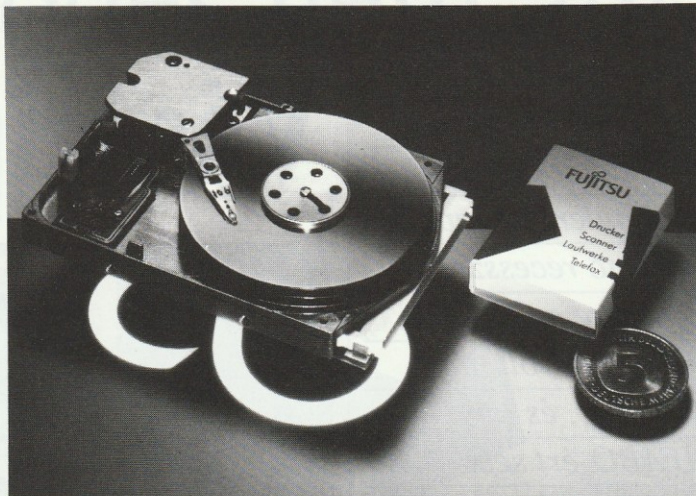
A Fujitsu 2,5"-os, 240 Mb-át kapacitású winchestere mindössze 17 mm magas. Adatátviteli sebessége 10 Mb-át/s
