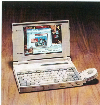
Az olcsó, T1900C típusjelű notebook PCMCIA csatlakozón keresztül bővíthető
