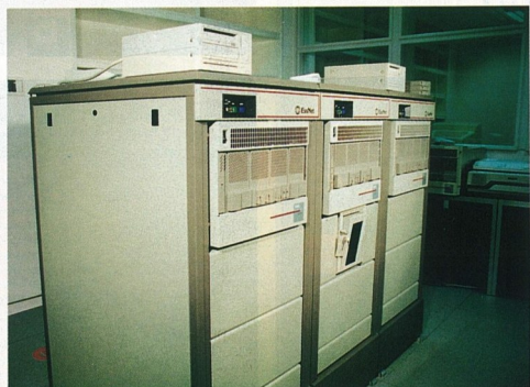
▲ A Szerencsejáték Rt. elektronikus rendszerének központi egysége. A gépek tetején az egyszerűen írásható optikai tárcák láthatók
