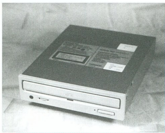
A Sony CDU31A-02 normál sebességű, beépíthető, AT csatolás változat
