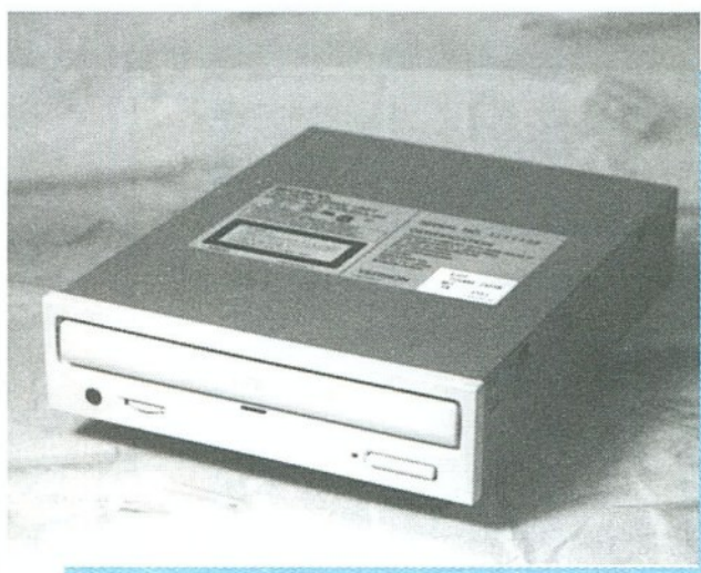
A Sony CDU31A-03 kétszeres sebességű, belső, AT buszos meghajtó
