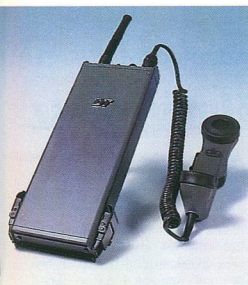
▲ Tele Security Timmann szórt spektrumú rádióadója a frekvenciaváltást rejtjelezi
