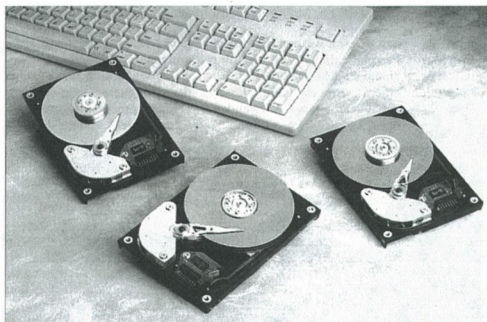
A Az új Conner Filepro Advantage sorozat nagy tárolókapacitású lemezeket kínál: egy-egy modellen több mint 400 Mbájtnyi hely van
