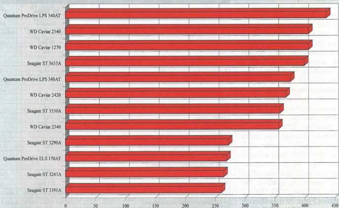
A CP teszt eredménye cache-kontrollerrel mérve (csak IDE típusok)
