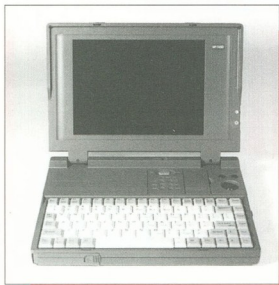
▲ A Mikropo NP-743D notebookján más egységeket, például modemet csatlakoztathatunk a trackball helyére
