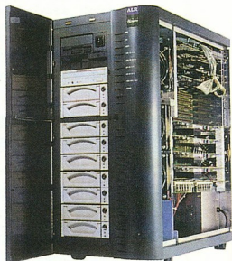
Négy Pentium processzorral bővíthető az ALR Revolution Q-SMP multiprocesszoros szerver
