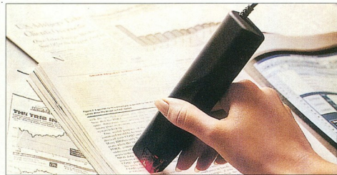
A DataPen szövegszkennert karakterfelismerő (OCR) képességekkel vértették fel
