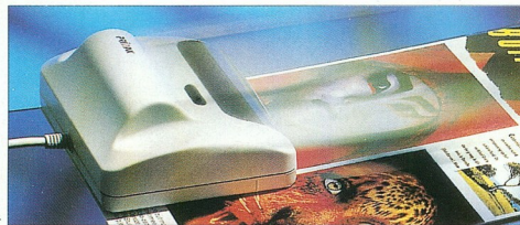
A DataPen szövegszkennert karakterfelismerő (OCR) képességekkel vértették fel
