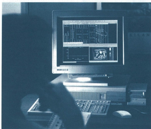
▲ A HP 9000 Series 700 sorozat 735-ös modellje 125 MHz-en működő PA-RISC 7150 mikroprocesszorral épül
