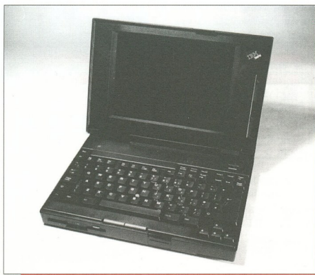
Az IBM ThinkPad 340-es notebook roppant precíz készülék. Bővíteni PCMCIA kártyákkal lehet
