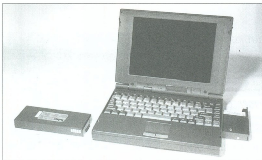
A Tulip notebook is moduláris felépítésű, a floppy helyére CD meghajtó szerelhető
