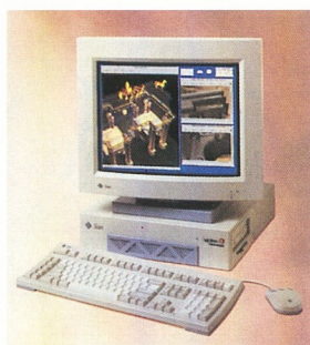
A Silicon Graphics Indy sorozatának grafikus képességei kiemelkedők (felső kép) A Sun Ultra SPARC munkaállomása 2D és 3D gyorsító technológiával rendelkezik (alsó kép)
