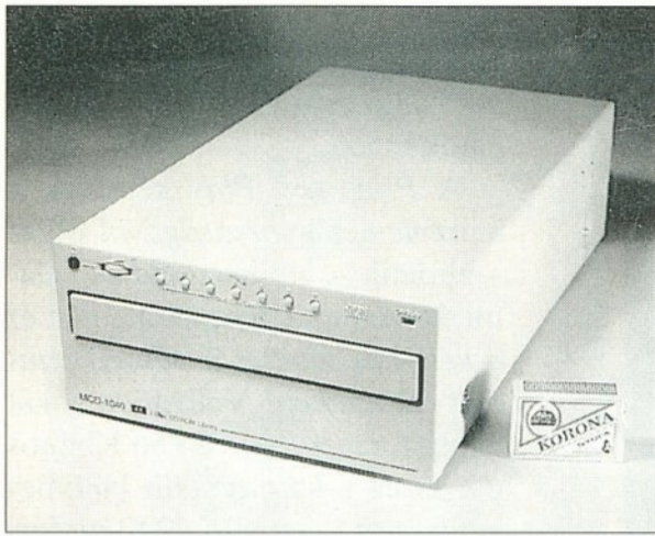
A Nakamichi MCD-1040 hétlemez CD-ROM-cserélő készülék. A külső periféria SCSI típusú és négyszeres sebességű
