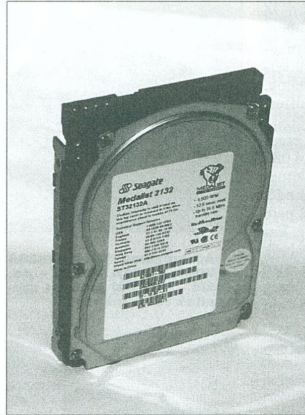
7. A Seagate ST32132A merevlemez másik két társától eltérő tokozást kapott, és a kapacitása is nagyobb: 2,1 Gbájt
