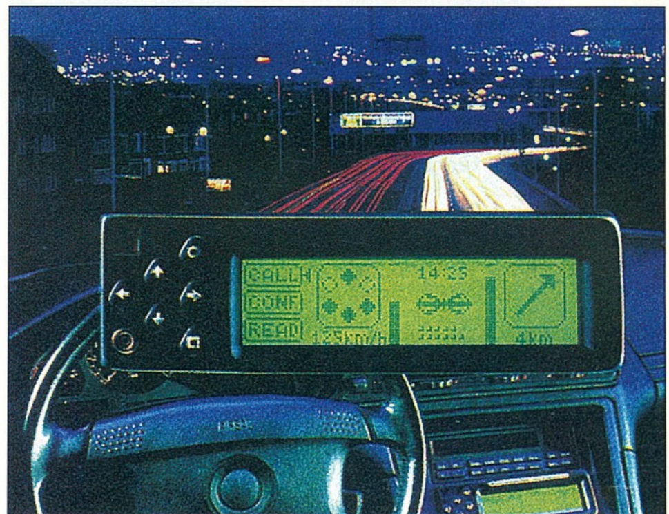
A Comroad cég Street Machine készüléke a GPS-GSM kombinációval az aktuális forgalmi helyzetnek megfelelően navigálja a vezetőt
