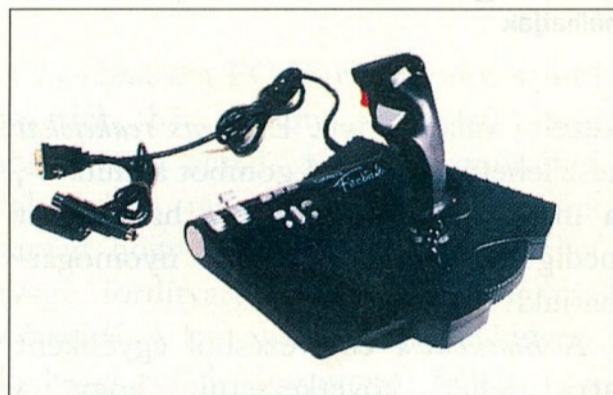
A Gravis Firebird II rugóereje – csakúgy, mint a Thunderbirdé – irányonként hat fokozatban állítható
