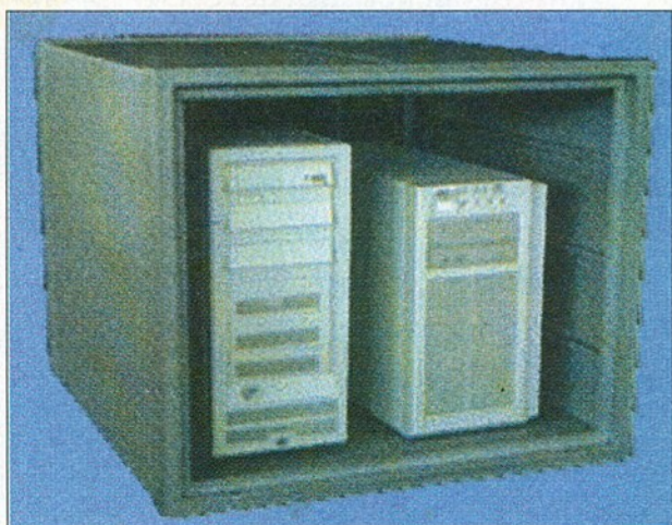
A számítógép és a szünetmentes tápegység a Fortress nevű acélkonténerbe zárva
