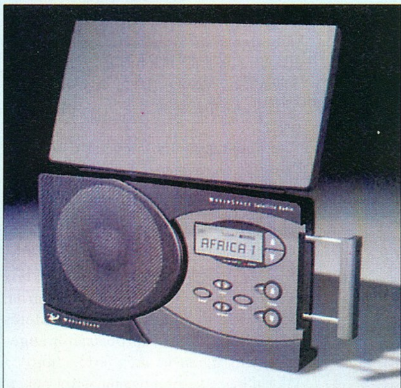
A WorldSpace rádióvevő prototípusa síkantennával. A chipkészleteket az ITT Intermetal és az SGS Thomson gyártja
