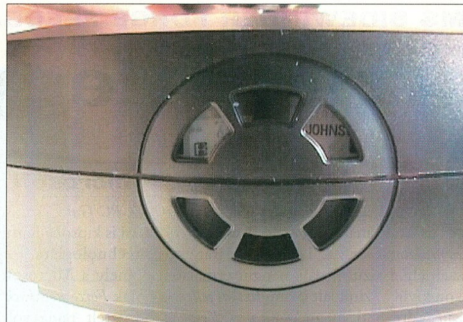
A motorok kis szellőzőnyíláson kapják a hűtéshez a levegőt
