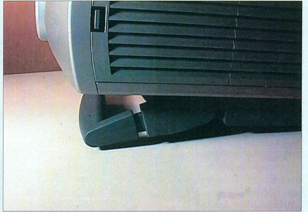
Szellemes megoldás, hogy a készülék szállítására szolgáló fogantyú állítható lábként is használható
