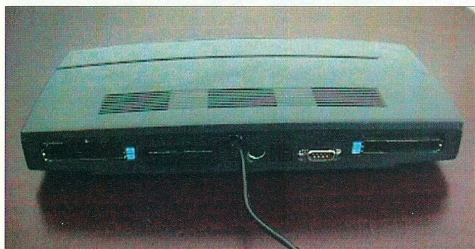
A HomePilot hátulján csatlakozók vannak, például soros port, telefonos és EuroScart-csatlakozó
