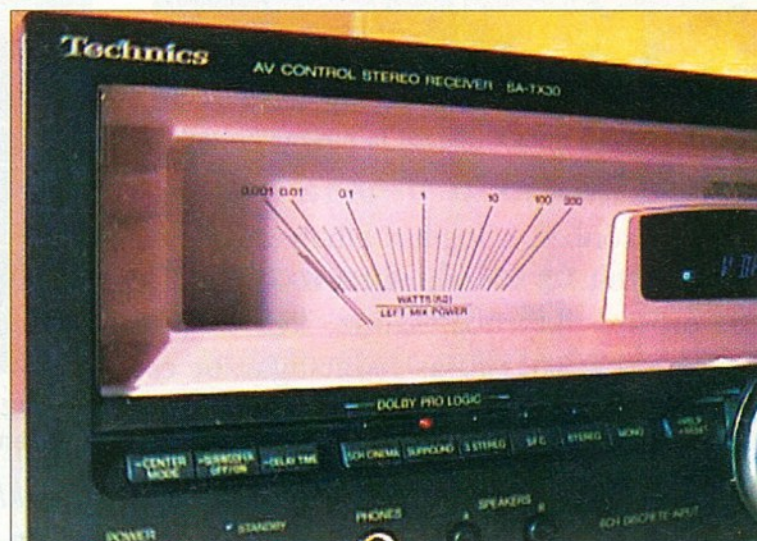
Az előlapon található a műszeres teljesítményt mérő és a beállításokat mutató képernyő
