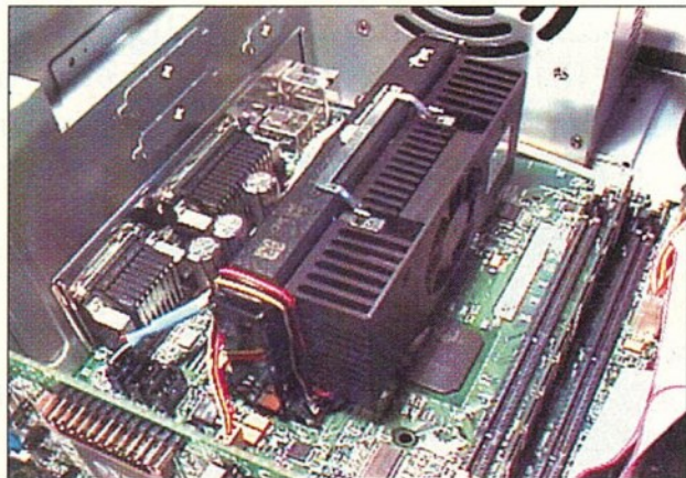
Nagy méretű, aktív hűtőborda vigyáz a processzor megfelelő hőmérsékletére
