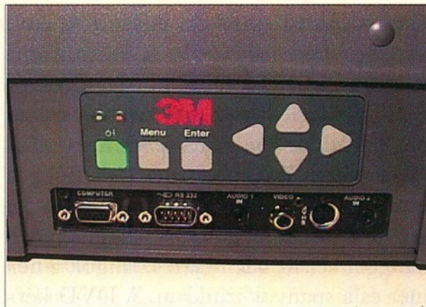
A vetítő hátulján vannak a csatlakozók és a kezelőgombok
