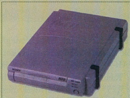
A HiFD meghajtó első verziója csak nyomtatóinterfészes kivitelben készült, ám hamarosan megjelennek a belső változatok is
