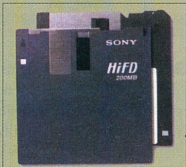
A védőlemez mögül hiányzó rés meggátolja, hogy a 200 Mbájtos lemezt az 1,44 Mbájtos helyére tegyék
