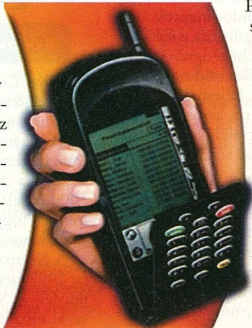
A Qualcomm pdQ Smartphone egy készülékben integrálja a mobiltelefont és a kézisámítógépet
