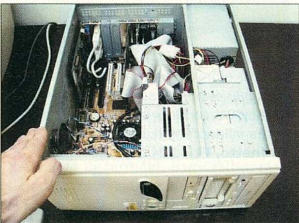
▲ 9. Döntsük oldalra a számítógépet. Mielőtt belenyúlnánk, földeljük le magunkat, például fogjuk meg a radiátort vagy a számítógépházat (ez utóbbi esetben a hálózati kábelnek a helyén kell lennie).
