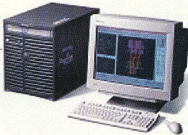
A HP Visualize J7000 munkaállomás „titka” a négy 440 MHz-es PA-RISC processzor
