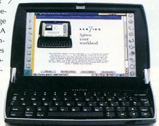
A Revo kézi számítógépe és az 53 gombos billentyűzet (fent) A Psion Series 7 -et VGA képernyővel szerelték fel (jobbra)
