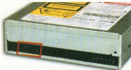
Itt kell a meghajtó azonosítóját (ID) és a lezáró ellenállást beállítani
