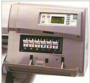
5. Az 5000PS változat beépített PostScript RIP-et tartalmaz
