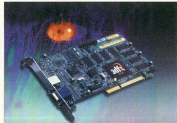
A 4500 típusjelű kártyán 32 Mbájtnyi RAM kaptott helyet
