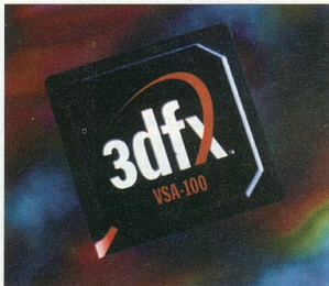
A VSA-100 processzor a Voodoo Scalable Architecture technológia első megvalósítása
