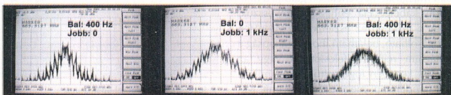
A frekvenciamodulált vivőfrekvencia spektruma
