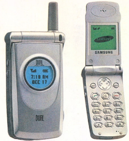
Becsukott állapotban láthatjuk, ki telefonál, vagy hogy üzenetünk érkezett (balra) A belső, nagyméretű képernyő kényelmessé teszi a wap-böngészést (jobbra)
