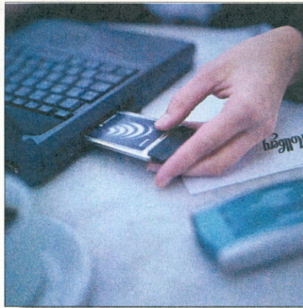
Ma még kevés számítógép rendelkezik beépített Bluetooth porttal, ezeken segít a PCMCIA kártya
