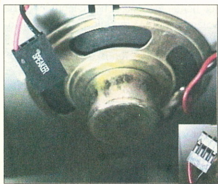
A hangszóró valahol a készülékházban kapott helyet. Egy kéterű, csatlakozós végű vezeték lóg ki belőle
