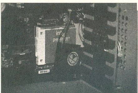
Ha az egykor felragasztott ventilátor leválik, már csak idő kérdése a processzor hőhalála
