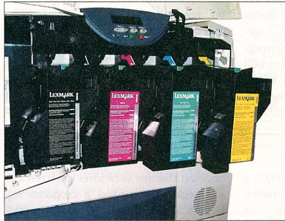
Különálló fényhengerek a nagy méretű tonerkazettákkal a Lexmark C750-ben
