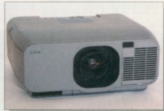
A NEC GT950-ös kivetítője 90 fokban elfordítható a Pivot Pro szoftver jóvoltából
