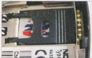
A telefon hátlapját és az akkumulátort is el kell távolítani, hogy megtaláljuk az adatsatlakozót
