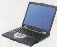
1,13 GHz-es mobil Pentium III-M processzor és 20 Gbájtos merevlemez lapul a Compaq Presario 1700-ban
