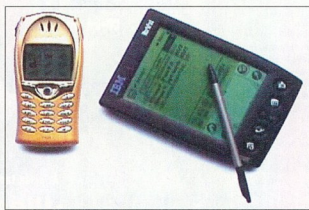
A GPRS adatkapcsolat létrehozásához fordítsuk egymás felé a telefon és a palmtop infracsatlakozóját
