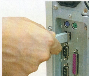
Mielőtt a kábelt a PC-hez csatlakoztatjuk, győződjünk meg róla, hogy ki van-e kapcsolva a fényképezőgép
