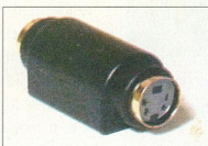
Az S-video hátulján rendszerint egy sokpólusú SCART csatlakozót találunk (képünkön egy adapter látható)
