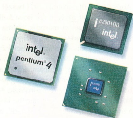
845GE: DDR333 memóriák támogatása, 533 MHz-es rendszerbusszal, hipertöbbszálúság és integrált grafikus mag.
